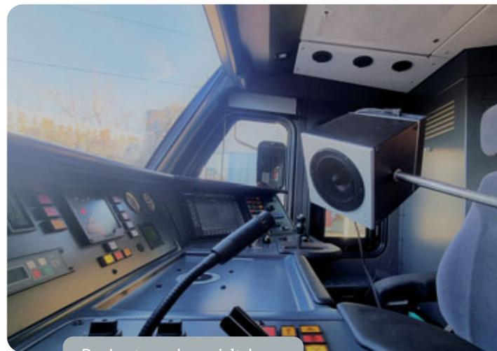
Der Lautsprecher spielt das Testsignal in das Mikrofon des Triebfahrzeugführers ein.
