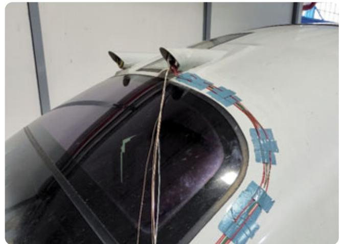
Eine wichtige Komponente ist dabei die Aufprallerkennung („Impact Detection“), die es ermöglicht, sowohl Aufprälle und Einschläge auf die Zugfront korrekt einzuordnen als auch angemessene Reaktionen für den automatisierten Fahrbetrieb abzuleiten. Dieses Verfahren soll am DB-Testzug „Advanced TrainLab“ erstmals erprobt werden.
