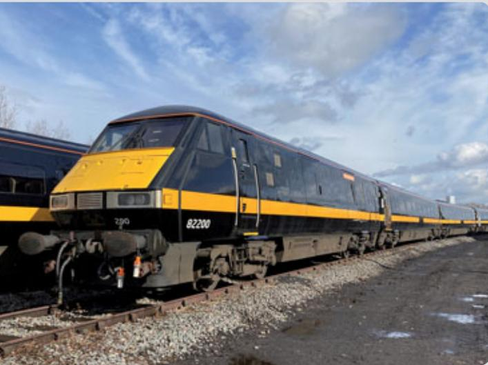
Transport for Wales (TfW) benötigte vier zusätzliche fünfteilige Garnituren von Reisezugwagen des Typs Mark 4, die zusammen mit einer Class-67-Lokomotive und einem Steuerwagen eingesetzt werden sollten. Diese Fahrzeuge waren nicht miteinander kompatibel. Deshalb waren Umbaumaßnahmen erforderlich, um ihren Einsatz als Zugsinheit im kommerziellen Betrieb zu ermöglichen.
