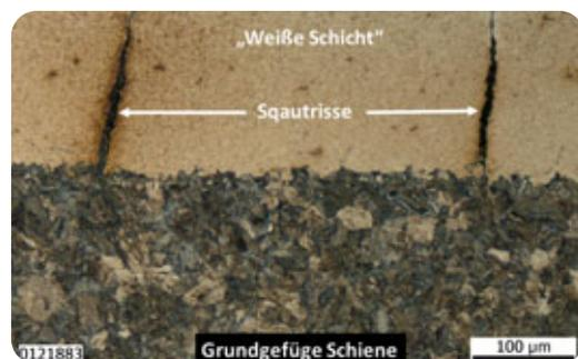
Im Rahmen des Projekts wurde zudem der Einfluss der Höhe von Traktionskräften sowie von Umwelteinflüssen („feuchte Schiene“) auf die Entwicklung von Squatrisse untersucht. Im Ergebnis hat sich noch kein geschlossenes Bild gezeigt. Dennoch ermöglichen die Prüfstandsversuche eine Analyse einzelner Einflussfaktoren auf das Squatwachstum unter kontrollierten Bedingungen, wie sie durch Untersuchungen im Gleis nicht erreicht werden können.
