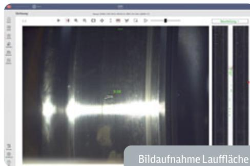
Bildaufnahme Lauffläche mit Vermessung eines Fehlers
