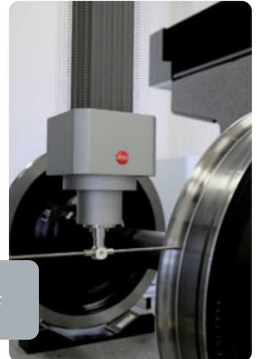
Für die Fertigung, den Betrieb und die Instandsetzung von Radsätzen werden Radsatzbearbeitungsmaschinen und Radsatzmesssysteme verwendet. Die Bearbeitungsmaschinen werden für die Herstellung und Reprofilierung der Radsätze genutzt, die Messsysteme für die Fertigungssteuerung und die Überwachung der Radsätze im Betrieb. Mit beiden werden die geometrischen Eigenschaften der Radsätze gemessen und die Messergebnisse werden für die Konformitätsbewertung der Radsätze verwendet.
