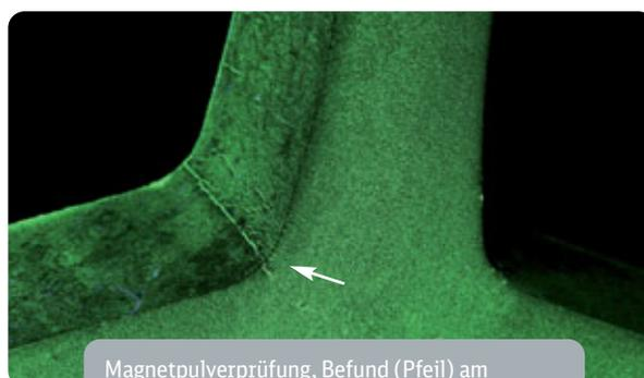
Magnetpulverprüfung, Befund (Pfeil) am Makroquerschliff, Aufnahme unter UV-Licht
