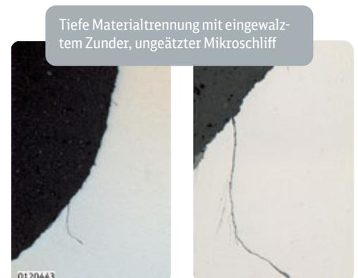
Tiefe Materialtrennung mit eingewalztem Zunder, ungeätzter Mikroschliff
