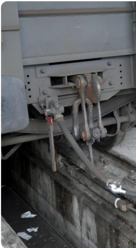
Vorder- und Rückansicht vom angeschlossenen Bremsprüfgerät MI-8 während der Prüfungen
