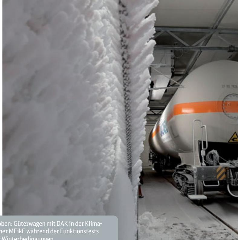
Bild oben: Güterwagen mit DAK in der Klimakammer MEiKE während der Funktionstests unter Winterbedingungen
