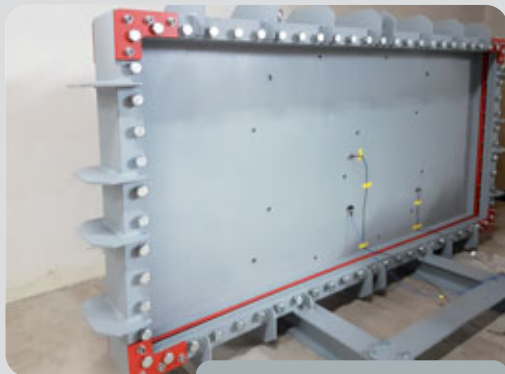
Vorderseite des Testsystems mit drei Schwingungsaufnehmern
