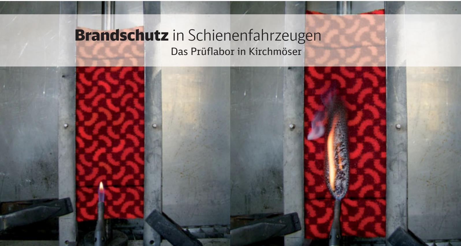
**Die europäische Norm EN 45545 hat 2016 die nationalen Normen zum Brandschutz in Schienenfahrzeugen abgelöst. Sie definiert u.a. Grenzwerte für den Beitrag der verwendeten Werkstoffe zu den einzelnen Brandrisiken.**
