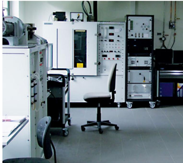
**Smoke Density Chamber zur Bestimmung der Rauchgastoxizität und Rauchentwicklung**
