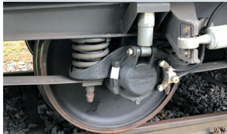
Radsatz im Messdrehgestell des Schallmesswagens mit Beschleunigungsaufnehmern am Achslagergehäuse
