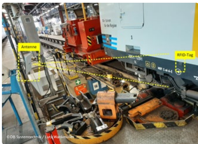
Abb.2: Antennenaufbau an einer Radsatzdrehmaschine
