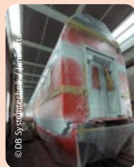
Verwendung einer farbgebenden Grundierung, dadurch Entfall einer Lackschicht
