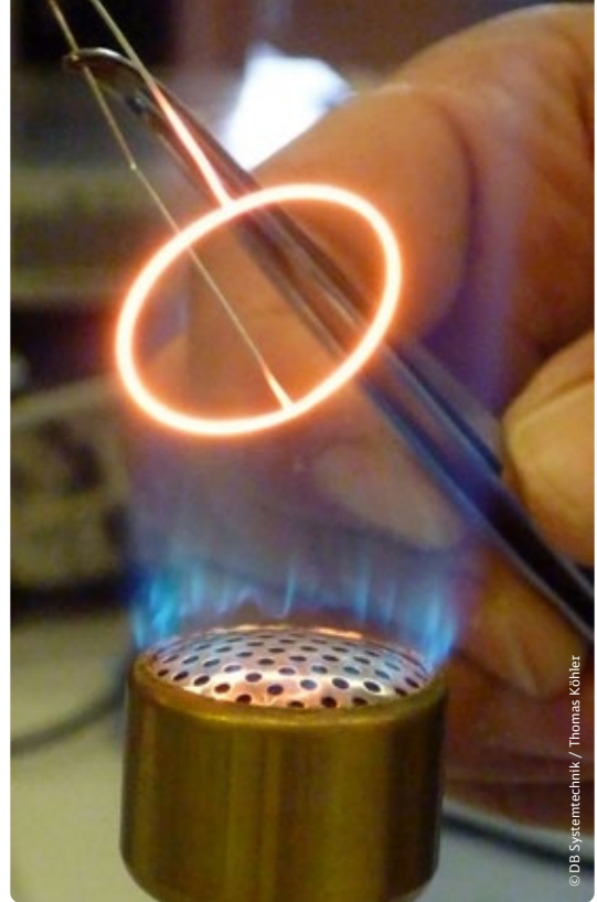
Abb. 1: Vorbereitung Platindraht zur Messung der Grenzflächenspannung
