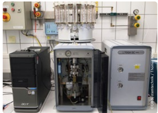
Abb. 3: Messaufbau zur Gas-in-Öl-Analyse
