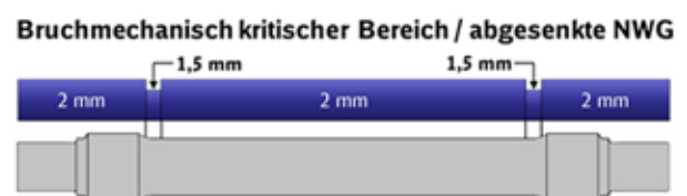
Abb. 3: Bereiche mit abgesenkter Nachweisgrenze zur Verlängerung des UT-Prüfintervalls
