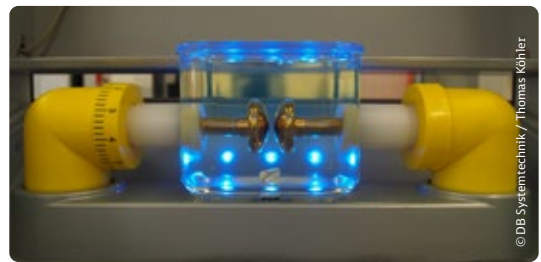
Abb. 2: Bestimmung der Durchschlagspannung
