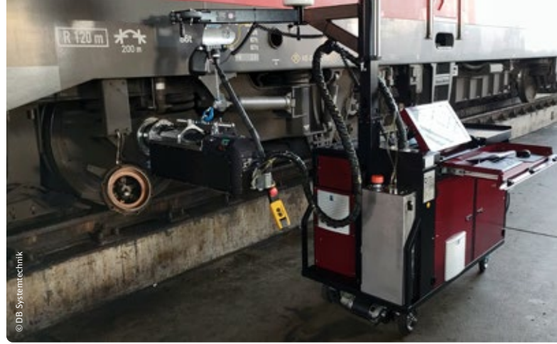
Abb. 1: Beispielhafte Prüfung einer Radsatzwelle am Fahrzeug mit einer mechanisierten Ultraschallprüfanlage
